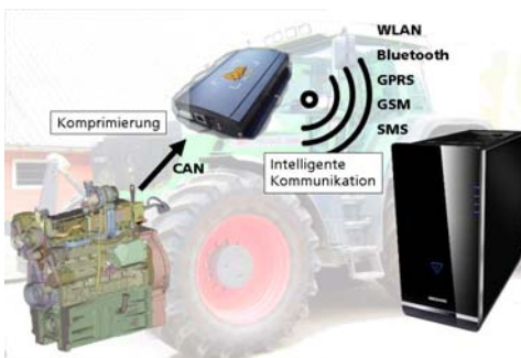
Abb. 3: Datenmanagement für den Teleservice bei mobilen Arbeitsmaschinen
